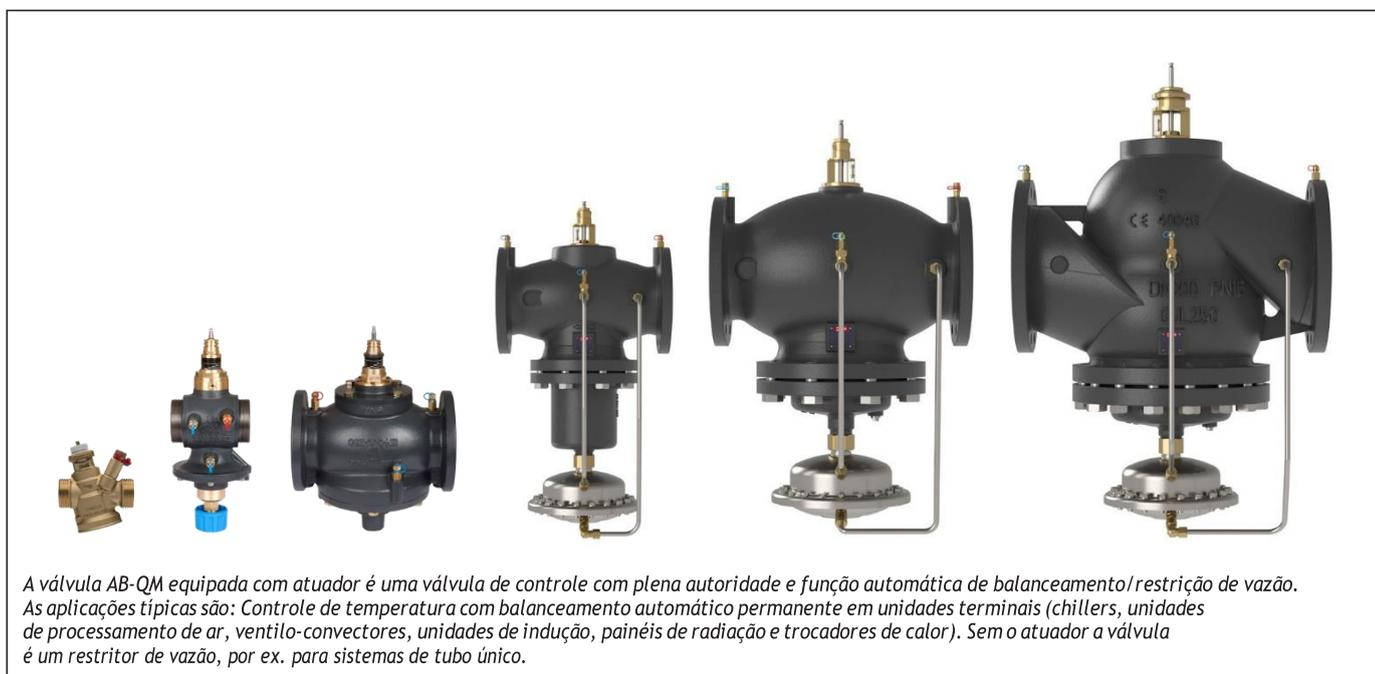
A válvula AB-QM equipada com atuador é uma válvula de controle com plena autoridade e função automática de balanceamento/restricção de vazão. As aplicações típicas são: Controle de temperatura com balanceamento automático permanente em unidades terminais (chillers, unidades de processamento de ar, ventilo-convectores, unidades de indução, painéis de radiação e trocadores de calor). Sem o atuador a válvula é um restritor de vazão, por ex. para sistemas de tubo único.
