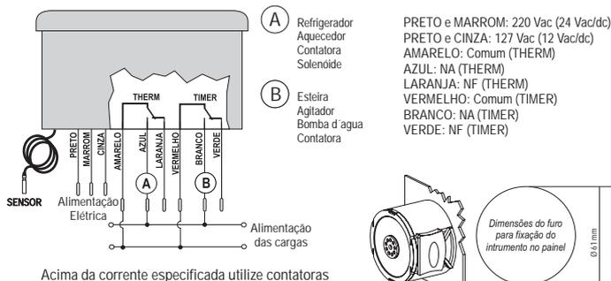
Nota: O comprimento do cabo do sensor pode ser aumentado pelo próprio usuário até 200 metros, utilizando cabo PP 2 x 24 AWG. Para imersão em água utilize poço termométrico.
